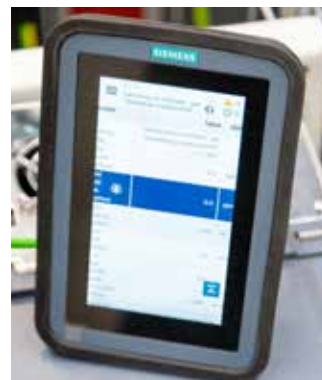
Das SINAMICS Smart Drive Interface erleichtert durch Klartextmeldungen die Bedienung und Beobachtung der Anlage sowie Wartung und Service vor Ort
